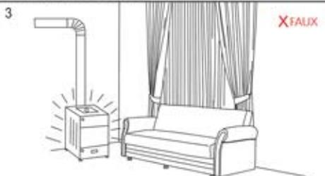
Gardez votre produit loin des sources de chaleur comme recommandé ci-dessous pour éviter des déformations qui pourraient occire sur la sellerie et les pièces de remplissage. Radiateur de combustible solide: minimum 1 mètre / Radiateur panneau: minimum 25 cm / Radiateur électrique: minimum 80 cm.
